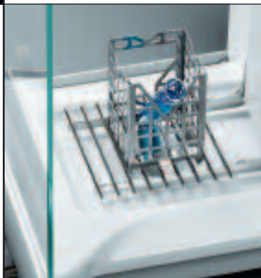
Контейнер для взвешивания пробирок с образцом. Уменьшает влияние электростатических зарядов.
