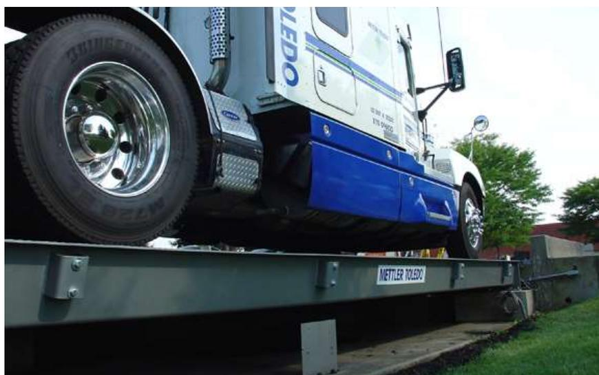
Модель VTS221 легко справляется с нагрузками стандартного потока грузовых автомобилей, распределяя сосредоточенные нагрузки более равномерно, чем конструкции с
